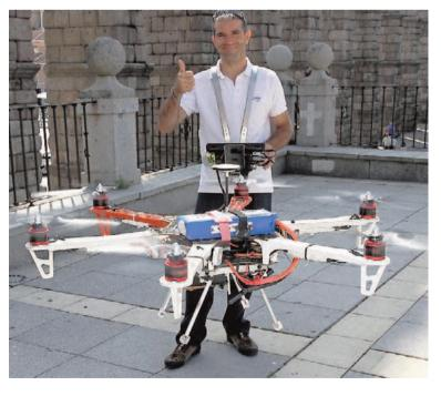
despegó. Funciona con un emisor y un receptor que le permite alejarse hasta dos kilómetros y medio, y asciende a tres metros por segundo (si no lleva cargas lo hace a seis metros por segundo). Pero una de las cosas que más sorprende, sin duda, es su estabilidad, ya que no da ningún bandazo y Ángel Vilches lo maneja con una precisión milimétrica a través de un mando de
