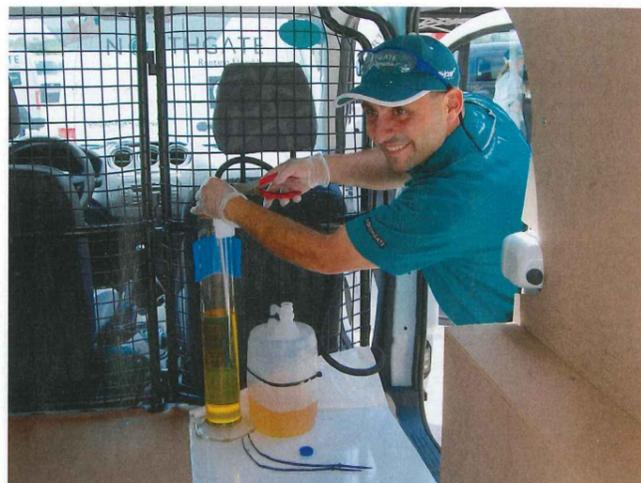
▲ **PROBETA.** Cada vehículo contaba con dos litros de gasoil para realizar las tres vueltas al circuito.
